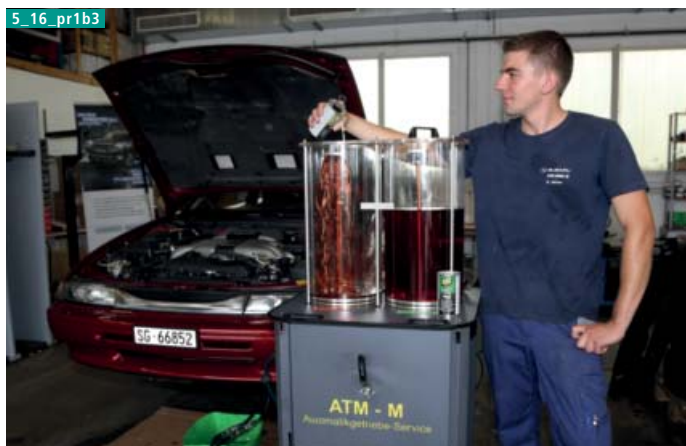
Bild 3. Marcel Müller, Automobil-Mechatroniker in der Garage Speer AG, füllt den «Quick Clean» in den Behälter «altes Öl» ein.
