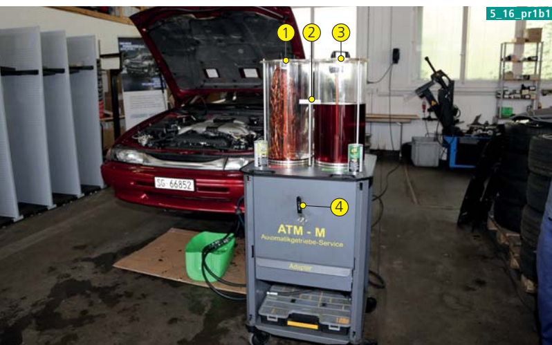
Bild 1. Das ATM-M-Automatikspülgerät hat die Herstellerfreigabe von Daimler, kostet 4800 Franken exkl. MwSt. und kann bei www.ashuki.ch bestellt werden. Mit dem Kauf des Geräts verbunden ist jeweils eine intensive Einführung vor Ort oder ein halbtägiger Kurs im Trainingscenter des Schulungspartners Autef. 1 Altölbehälter, 2 Markierung für Ölstand, 3 Frischölbehälter, 4 Rücklaufmengenventil.
